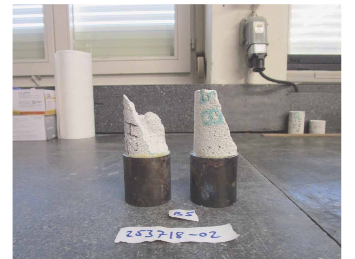
Zerstörte Siporex-Bohrkerne nach Haftzugfestigkeitsprüfung
